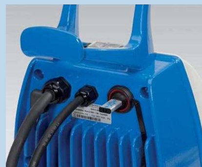
Port USB do transferu protokołów, antena GPS
